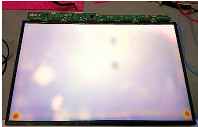
Degradierter Polarizer beim 17" Umbau von CCFL auf LED
